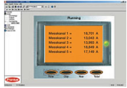
**FRONIUS String Control.** Die optionale Einzelstrangüberwachung. Pro Box können 25 Strings getrennt überwacht werden, bis zu 5.000 Strings in der Gesamtanlage. Noch mehr Sicherheit für zuverlässige Energiegewinnung.
