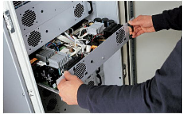
**Wechselbar.** Die einzelnen Platinen – bis zu 15 Stück – sind mittels Einschüben einfach herauszuziehen. Sie ermöglichen außerdem eine optimale Auslastung des Wechselrichters und damit maximalen Ertrag.
